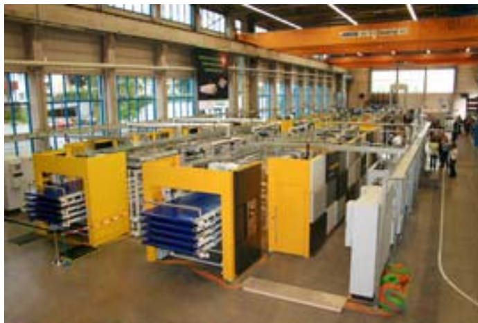
Fig. 4. Laminoare pentru module fotovoltaice
